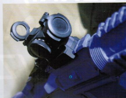
Pokrywka okularu ma przezroczysty środek, co umożliwia używanie celownika z zamkniętymi kłapkami – w takim przypadku T-2 działa jak kolimator nieprzezierny, co bardzo poprawia widzialność drobnej kropki na jasno oświetlonym tle
