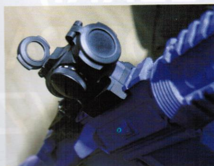
Pokrywka okularu ma przezroczysty środek, co umożliwia używanie celownika z zamkniętymi klapkami – w takim przypadku T-2 działa jak kolimator nieprzezierny, co bardzo poprawia widzialność drobnej kropki na jasno oświetlonym tle
