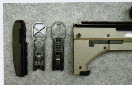
Regulacji długości kolby dokonujemy przez zdejmowanie lub dokładanie dystansowych podkładek, co z uwagi na ich konstrukcję jest czynnością bardzo prostą i szybką – zauważmy, że klasyczna regulacja kolby poprzez jej teleskopowe skracanie także odbywa się skokowo
